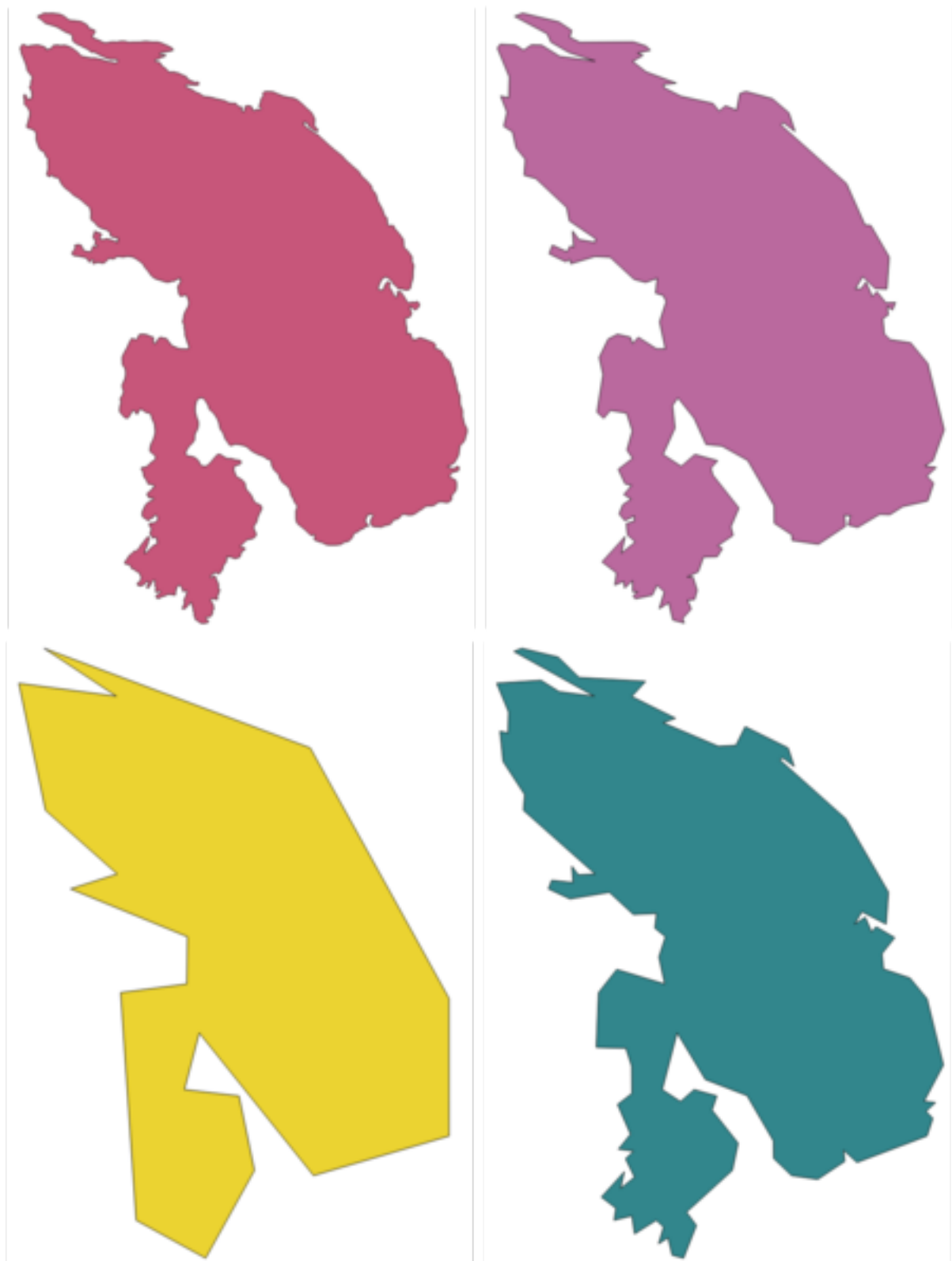
Fig. 24.79: Met de klok mee vanaf linksboven: bronlaag en vergrotende toleranties voor vereenvoudiging
