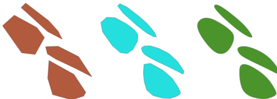
Fig. 24.81: L'aumento del numero di iterazioni causa geometrie più lisce
