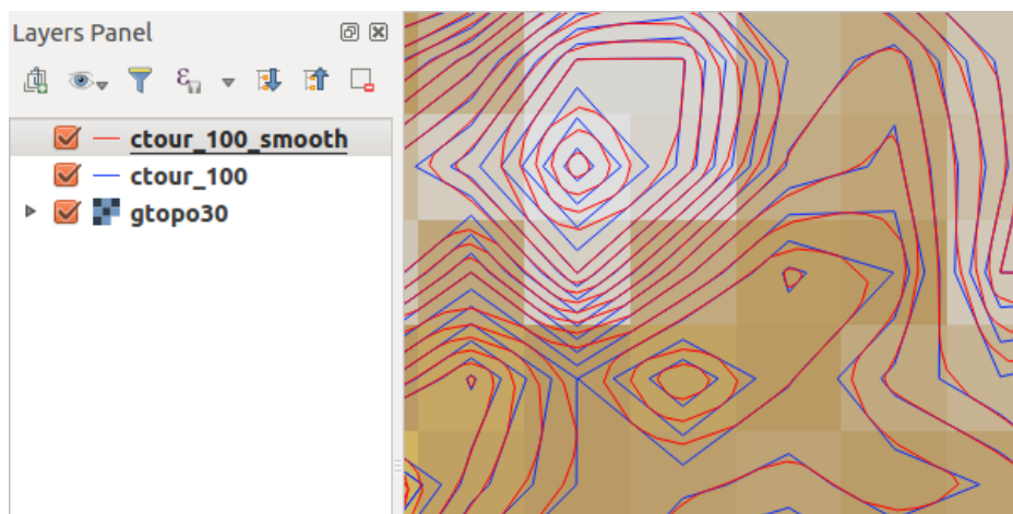
Fig. 22.7: GRASS modulo v.generalize per smussare una mappa vettoriale
