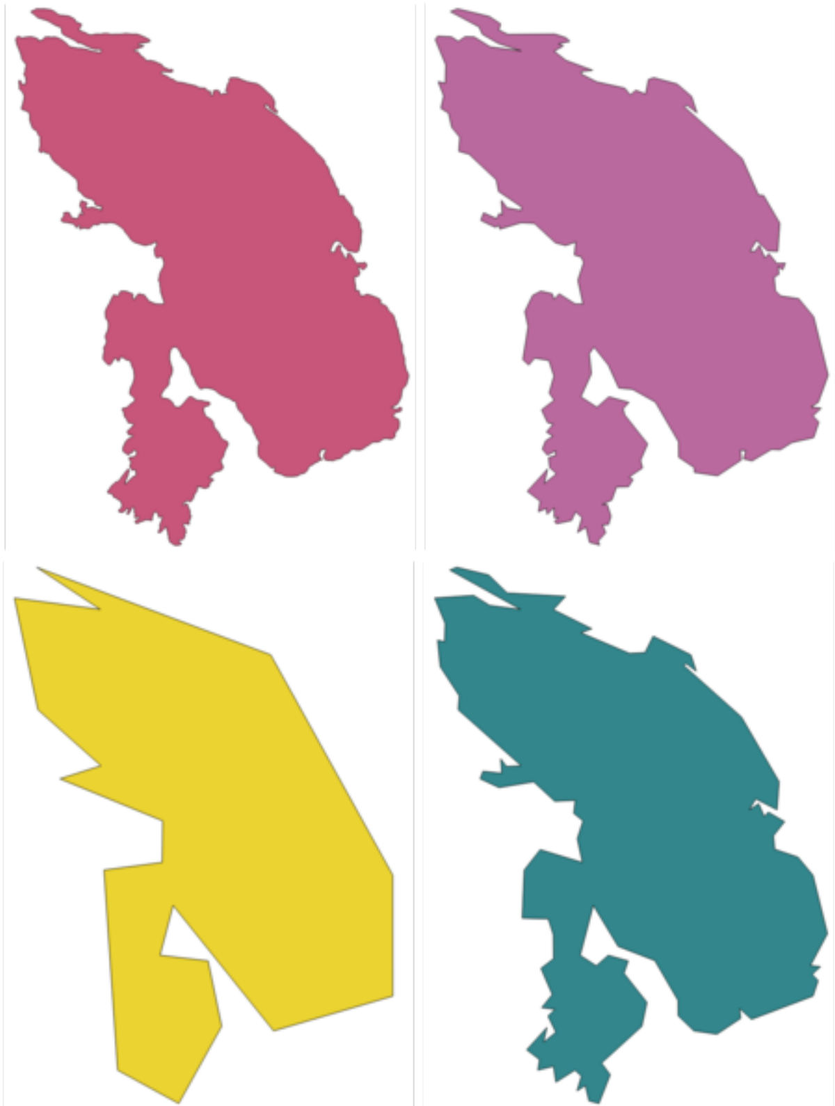
Fig. 24.79: In senso orario dall'alto a sinistra: layer di origine e aumento delle tolleranze di semplificazione
