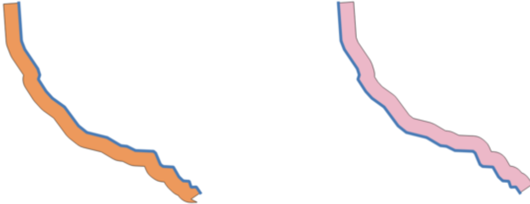
Fig. 24.80: Buffer laterale sinistro rispetto a quello destro sullo stesso layer del vettore lineare
