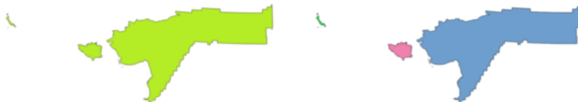
Figure 24.69: A gauche la couche source en plusieurs parties et à droite le résultat de sortie de la pièce unique
