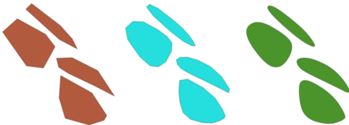
Figure24.81: L'augmentation du nombre d'itérations entraîne des géométries plus lisses
