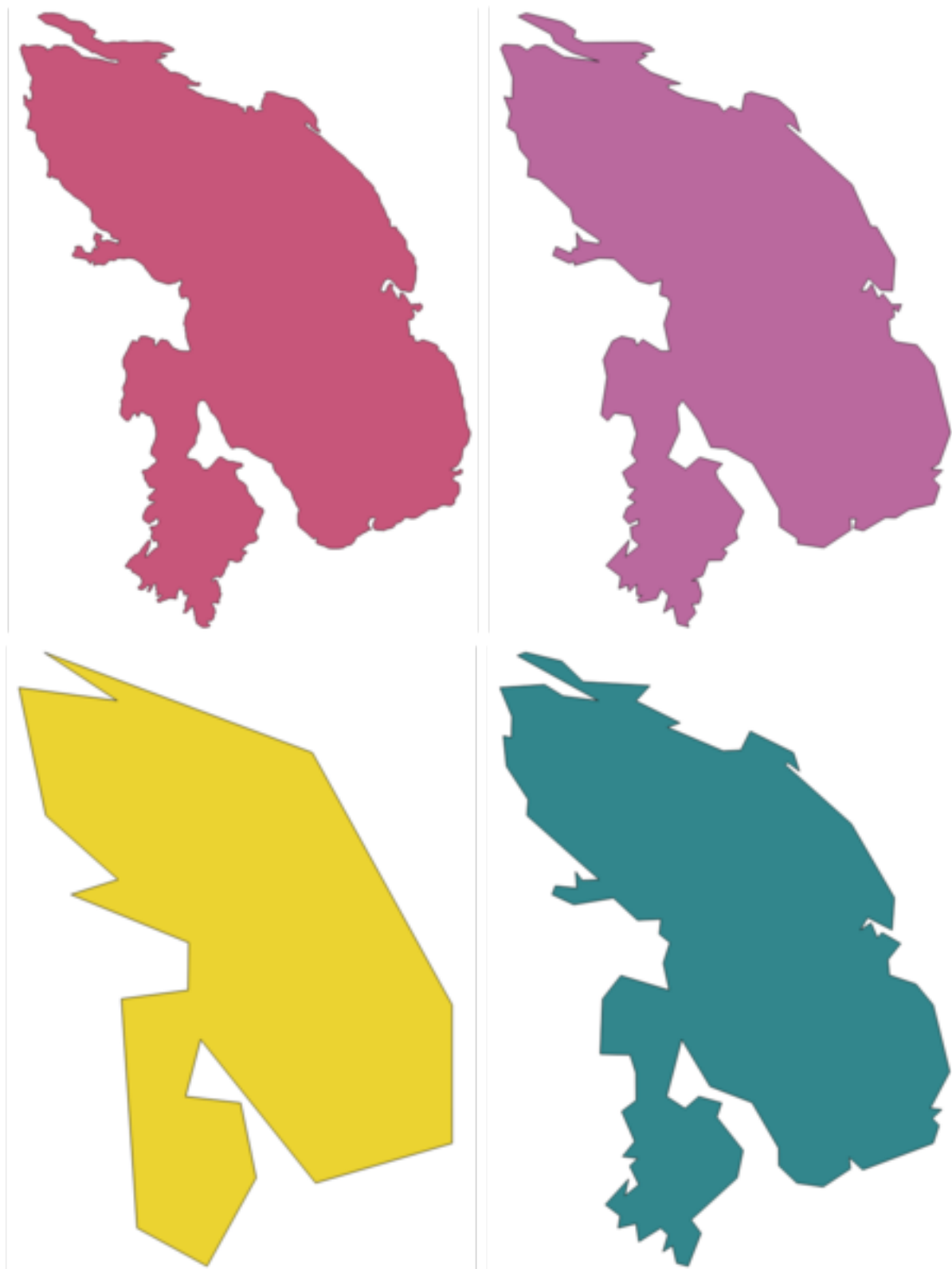
Figure24.79: Dans le sens horaire à partir du haut à gauche: couche source et augmentation des tolérances de simplification
